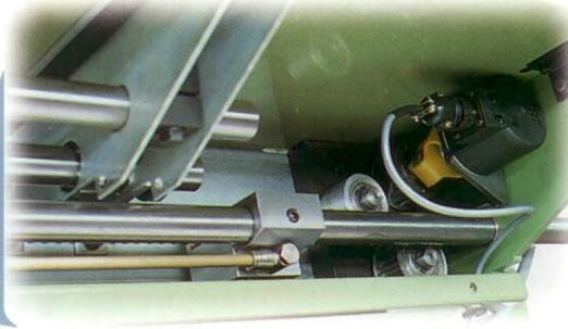
Un dispositivo di sincronizzazione del movimento dello spingibarra con il movimento della fantina permette di realizzare al meglio il collegamento con i torni CNC a fantina mobile.
